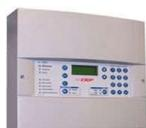
Centrale CA1000, 1 o 2 loop analogica indirizzata equipaggiata per gestire 128 indirizzi complessivi connessi su **2 loop o 4 linee aperte**, non espandibile, completa di alimentatore, pannello di gestione e comando, display LCD 4 x 20 caratteri, 5 relè liberamente programmabili, uscita sirena controllata 24 Vcc 800 mA, uscita ausiliaria 24 Vcc 400 mA, porta seriale RS232, porta seriale RS485 per pannelli ripetitori remoti, 2 ingressi programmabili. Certificata EN54-2 ed EN54-4
