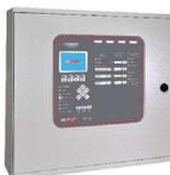
Centrale di rivelazione LEONIS, analogica indirizzata da **1 loop da 256 indirizzi espandibile a 4 loop**, in contenitore metallico, gestisce fino a **512 indirizzi** complessivi distribuiti su 4 loop. Completa di alimentatore, pannello di gestione e comando, display LCD grafico a colori da 3,5", 2 relè liberamente programmabili, uscita ausiliaria 24 Vcc 400 mA, porta USB, 2 ingressi programmabili. Certificata EN54-2 ed EN54-4. **Consente alloggiamento di 2 batterie da 18 A/h**
