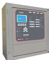
Centrale di rivelazione LEONIS, analogica indirizzata da **1 loop da 256 indirizzi espandibile a 4 loop**, in **contenitore metallico LARGE**. Gestisce fino a **512 indirizzi** complessivi distribuiti su 4 loop. Completa di alimentatore, 2 relè liberamente programmabili, uscita ausiliaria 24 Vcc 400 mA, porta USB, 2 ingressi programmabili. Certificata EN54-2 ed EN54-4. **Consente alloggiamento di 2 batterie da 42 A/h**
