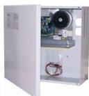
Unità di alimentazione 24 Vcc 2 A. Certificata CE CPD EN54-4 A2 e EN12101-10 per i sistemi di controllo a norma di evacuatori di fumo e calore. Batteria allocabile 2 x 12 Ah 12 V. Corrente disponibile per carichi esterni 1,5 A. Contenitore metallico CM02 (385 x 405 x 160 mm). Uscite a relè per guasto generale e mancanza rete
