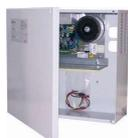
Unità di alimentazione 24 Vcc 12 A. Certificata CE CPD EN54-4 A2 e EN12101-10 per i sistemi di controllo a norma di evacuatori di fumo e calore. Batteria allocabile 2 x 24 Ah 12 V. Corrente disponibile per carichi esterni 10,2 A. Contenitore metallico (425 x 510 x 210 mm). Uscite a relè per mancanza rete, guasto batterie e guasto uscita
